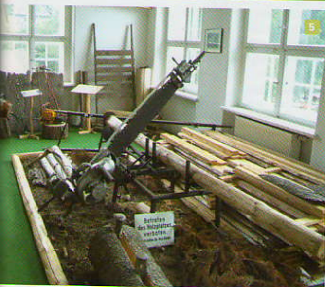
Abb. 5: Zweimannsäge Faun B/C als Kappsäge zum Einschnitt von Langholz im Wald
