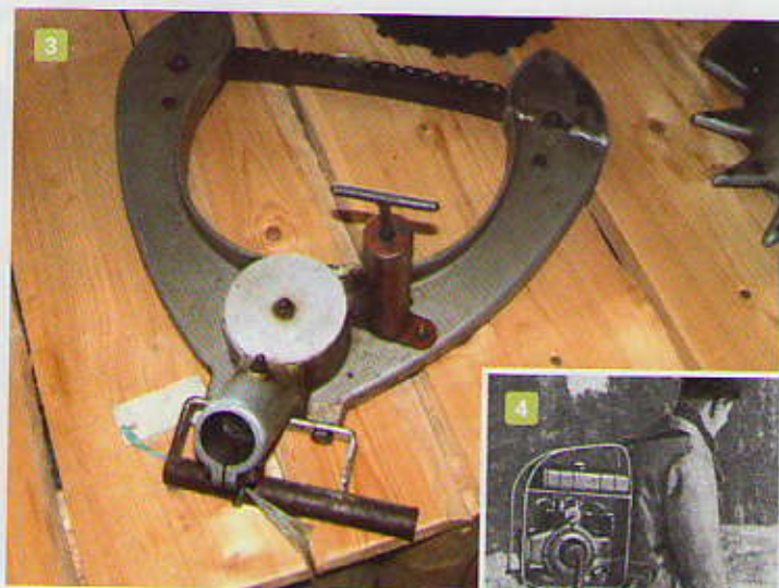
Abb. 3: Ungewöhnliches Ketten-Schneidgerät für eine rückentragbare Motorsäge wie in Abb. 4 (Abb. 4 aus HACHE, 1954)
